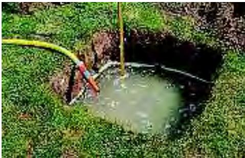
Ist die Vorbewässerung abgeschlossen, kann der eigentliche Versuch beginnen. Zur Auswertung verwenden Sie die nebenstehende Tabelle. Die Grube wird zunächst bis in Höhe der Mutterbodenschicht, also zirka 20 Zentimeter, mit Wasser gefüllt. Der Wasserstand (Ableseung am Zollstock) wird in die Tabelle eingetragen (Versuchsbeginn, Spalte B).
